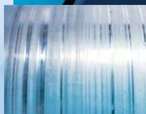
Stahl oder Kupfer verchromt: Streifenbildung
